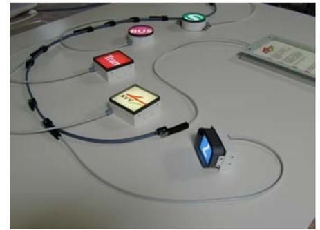
Bild 3 elektrische Verbindung der LED-Lichtmodule mittels Bustechnik
