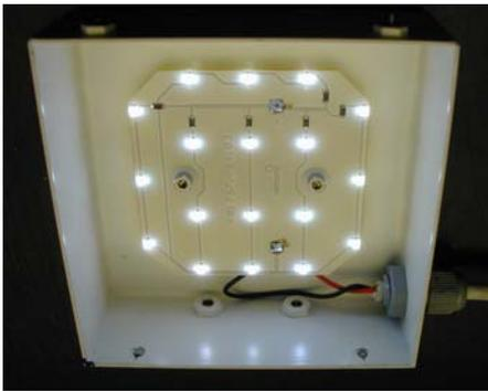
Bild 5 quadratisches LED-Lampenmodul mit weißen „Nichia“ SMD-LED
